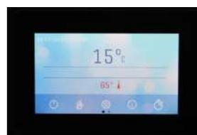
Controlo electrónico com painel táctil de última geração, com ignição automática (programação diária ou semanal), relógio para funcionamento automático, supervisão do equipamento eléctrico com mensagens de alarme por código de erro, controlo automático da combustão em função da temperatura ambiente e temperatura desejada.
